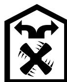
Nasáváný vzduch se čistí pomocí tukového filtru a aktivního uhlíkového filtru a přivádí se zpět do kuchyně.
